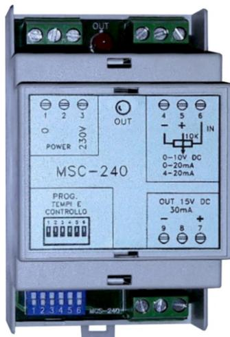
Questo modulo viene utilizzato per convertire i segnali di controllo in tempi proporzionali adatti a comandare i relè statici zero-crossing. Sono programmabili tramite dip-switch sia il segnale di ingresso che i tempi proporzionali di uscita.
