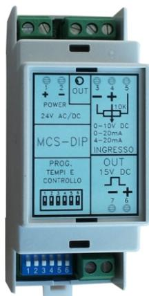
Questo modulo viene utilizzato per convertire i segnali di controllo in tempi proporzionali adatti a comandare i relè statici zero-crossing. Sono programmabili tramite dip-switch sia il segnale di ingresso che i tempi proporzionali di uscita.
